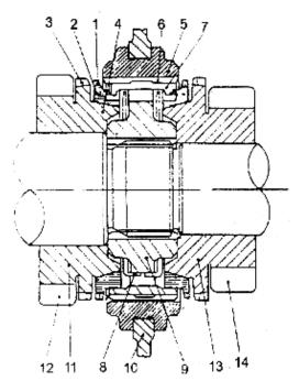
Fig. 2-3 Synchromesh Gear
