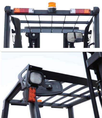
Les chariots de la série FD sont équipés, de série de lampes à LED, Blue spot, port USB, poignée arrière avec klaxon intégré, le tout afin d'offrir à l'opérateur le plus grand confort possible et une sécurité d'utilisation optimale.
