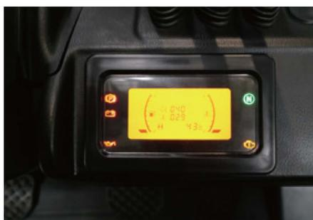
Le système de présence de l'opérateur (OPS), disponible de série, intègre une fonction de verrouillage automatique du levage/de l'inclinaison et de la conduite, lorsque l'opérateur quitte son siège. Cela permet de garantir une sécurité optimale pour l'opérateur.
