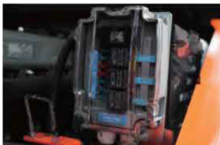
Les principaux composants électroniques sont protégés et logés dans un boîtier spécifique assurant ainsi une meilleure protection (température, vibrations, poussière, éclaboussures d'eau...)
