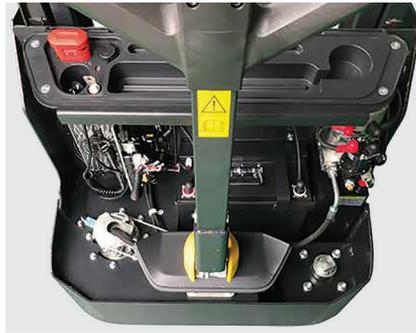
Das BMS "Battery Managing System" der Batterie überwacht die Lade- und Entladeparametern, die Betriebstemperatur und Kurzschlüsse. Die Kommunikation mit BMS und die Einstellung der Software ist über CAN-BUS möglich.
