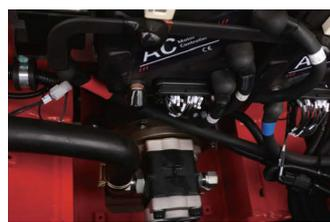
Le moteur de traction est situé en hauteur, ce qui permet de sécuriser l'utilisation de ce chariot en extérieur, notamment dans des environnements humides.
