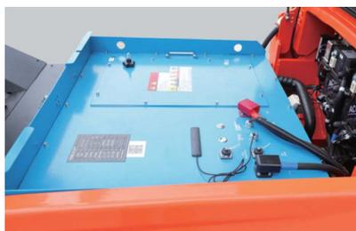
Les chariots de la série Q sont équipés de chargeurs ultra-rapide «minimum 100Ah», ce qui permet une charge complète de la batterie comprise entre 2 et 3 heures. 70% de la charge en seulement 45 minutes.
