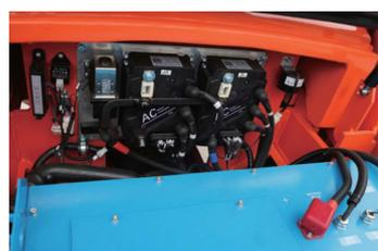
Sur le modèle FE4P25Q-35Q, les variateurs sont placés en hauteur pour une ventilation efficace et une maintenance aisée.
