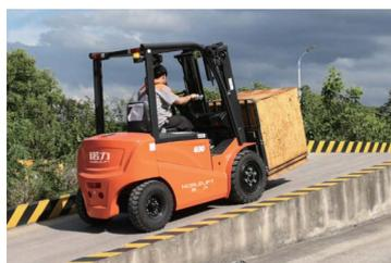
Il est équipé d'un frein de stationnement performant qui lui permet de stationner sur une pente de 15 % en toute sécurité avec sa charge.
