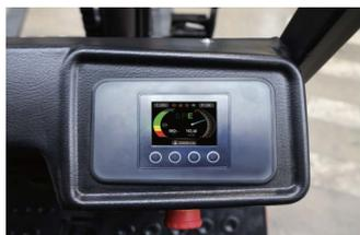
Le chariot élévateur est doté d'un nouvel écran LED ergonomique, grand format et d'une grande luminosité, qui assure un contrôle et une utilisation aisée, permettant d'obtenir des informations sur l'état de l'ensemble du chariot en temps réel.
