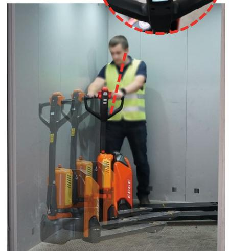
Der neue EDGE ist serienmäßig mit einem System ausgestattet, das es ihm ermöglicht, sich mit der Deichsel in der Vertikalen (90°) zu bewegen. Ideal für enge Räume (Aufzüge, schmale Gänge...).
