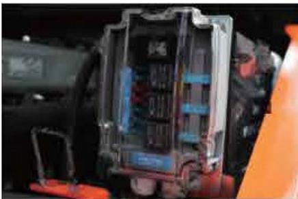
Die wichtigsten elektronischen Komponenten sind geschützt und in einem speziellen Gehäuse untergebracht, das einen besseren Schutz gewährleistet (Temperatur, Vibrationen, Staub, Wasserspritzer...).
