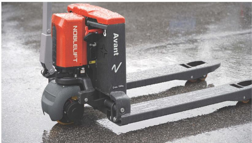
La conception classique en caisson fermé garantit une structure plus robuste avec des indices d'étanchéité à l'eau et à la poussière plus élevés.
