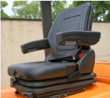
Operator Presence System (OPS) - Wenn sich der Fahrer nicht auf seinem Sitz befindet, werden die Hydrauliksteuerungen der Hebe- und Neigefunktion automatisch gesperrt und die Fahrt wird deaktiviert.
