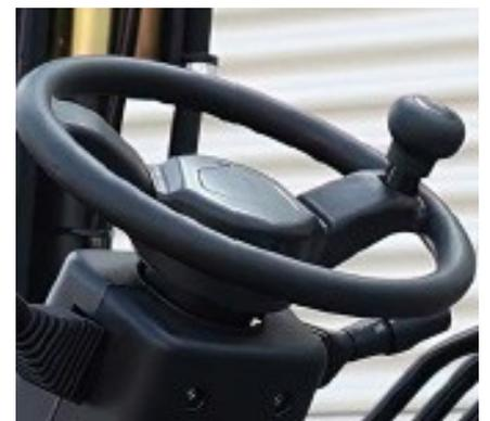
Die bedarfsgesteuerte vollhydrostatische Servolenkung (FHPS) sorgt für eine leichtgängige und präzise Lenkung.
