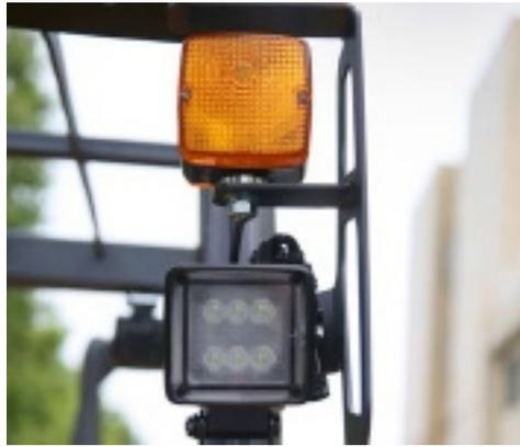
Serienmäßig mit LED-Lampen ausgestattet: Arbeitsrücklicht, Scheinwerfer, Stroboskoplicht und Sicherheitsblaulicht mit LEDs. Die serienmäßige Beleuchtung sorgt für optimale Sicht und Sicherheit.
