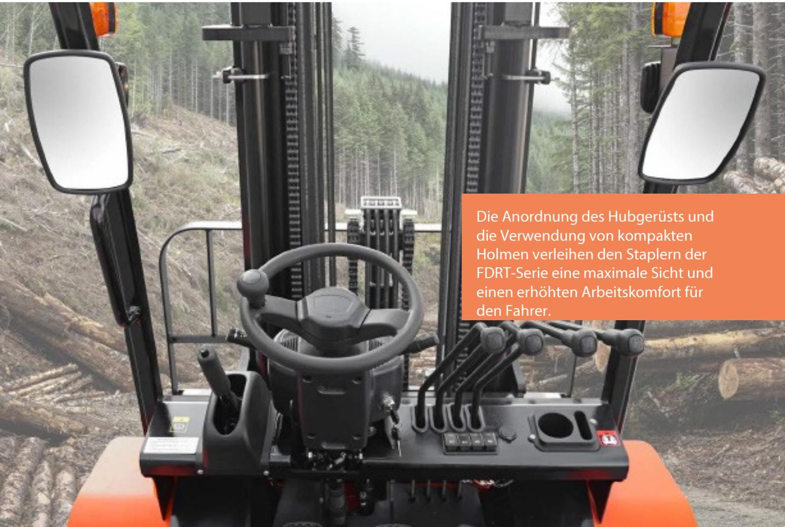
Die Anordnung des Hubgerüsts und die Verwendung von kompakten Holmen verleihen den Staplern der FDRT-Serie eine maximale Sicht und einen erhöhten Arbeitskomfort für den Fahrer.
