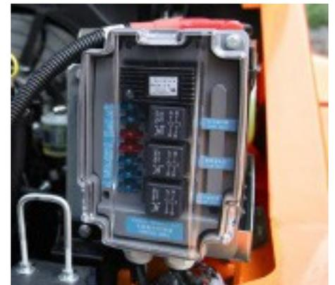
Der Controller, in dem alle elektrischen Komponenten integriert sind, wird durch ein spezielles, leicht zugängliches Gehäuse vor Temperatur, Wasser und Vibrationen geschützt.
