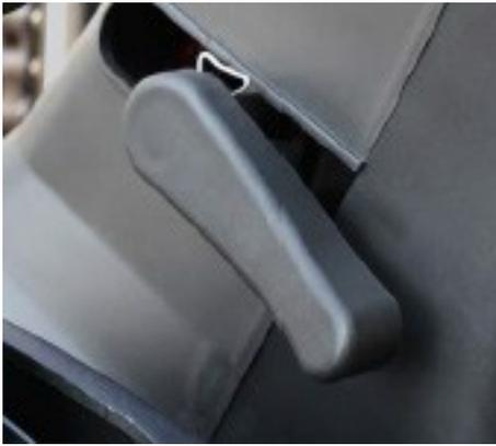
Der Winkel der Lenksäule lässt sich mithilfe eines Hebels auf der linken Seite der Lenksäule leicht verstellen.
