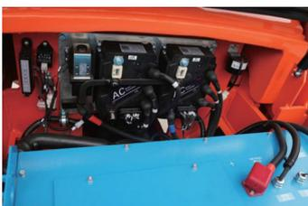
Beim Modell FE4P25Q-35Q sind die Dimmer hoch angebracht, um eine effektive Belüftung und einfache Wartung zu ermöglichen.
