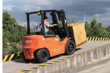
Er ist mit einer Feststellbremse ausgestattet. Die Last kann sicher auf einer Steigung von 15 % geparkt werden.
