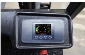
Der Gabelstapler ist mit einem neuen, ergonomischen, großformatigen LED-Bildschirm mit hoher Helligkeit ausgestattet, der eine einfache Kontrolle und Bedienung gewährleistet und Informationen über den Zustand des gesamten Staplers in Echtzeit liefert.
