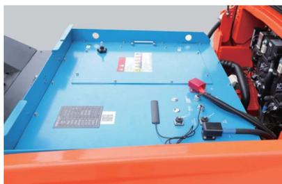
Die Stapler der Q-Serie sind mit ultraschnellen "minimum 100Ah"-Ladegeräten ausgestattet, die eine vollständige Aufladung der Batterie innerhalb von 2 bis 3 Stunden ermöglichen. 70% der Ladung in nur 45 Minuten.
