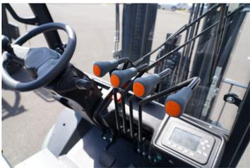
Die Elektrostapler der Q-Serie sind serienmäßig mit einem neuen ergonomischen Lenkrad mit reduziertem Durchmesser ausgestattet, das mit einem Lenkradball versehen ist. Der Stapler ist außerdem mit einem vorderen Mehrwegeventil ausgestattet, das die Arbeit komfortabler macht.
